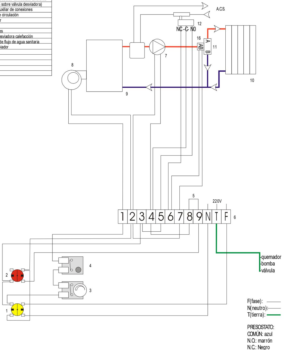
NOTA: Para hacer que la bomba de circulación funcione continuamente en posición Verano, a fin de que no pare aunque no haya demanda de A.C.S., se deberá cambiar el cable de color marrón que parte de la regleta de conexiones del número 4 hacia la bomba y colocarlo en el número 3.
